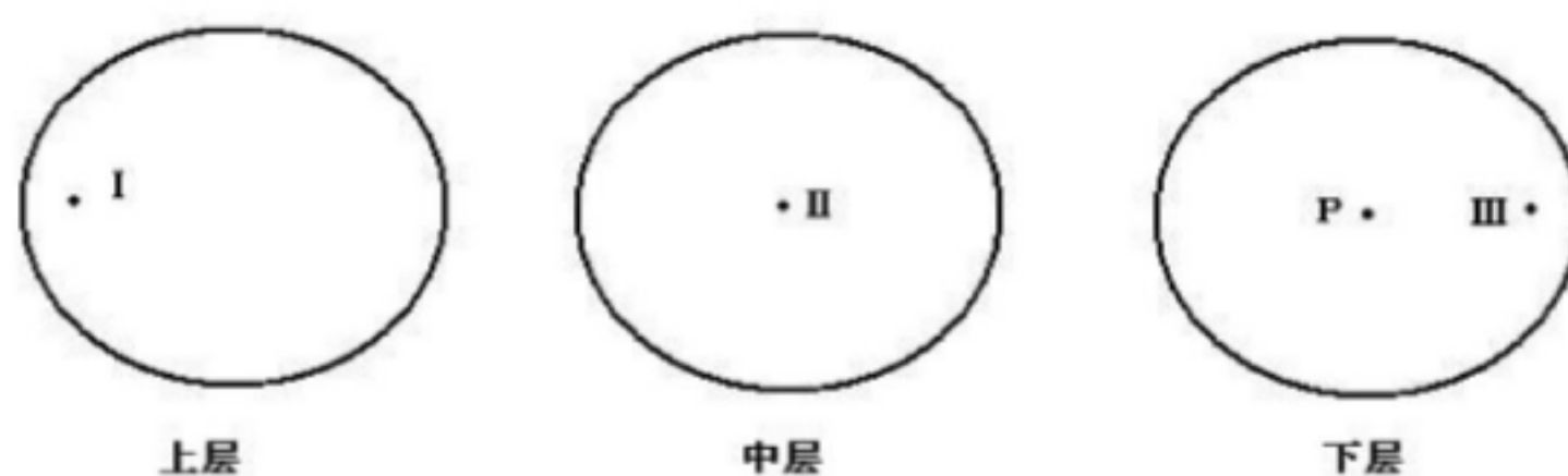
图1 测度测量点布置参考图（容积 20L 及以下）
